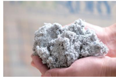
デコスドライ工法は、水や接着剤を使用せず、通気性のあるポリエステル不織布を張って、その中にセルロース断熱材を充填する。専門業者による責任施工
